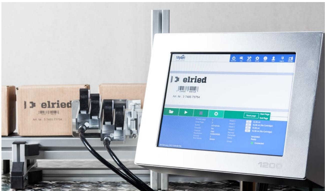
Der XL 1200 druckt hochauflösende Texte und Grafiken mit bis zu 50 mm Druckhöhe. Er bietet dank seiner Kartuschentechnologie hohe Druckqualität (600 dpi) und maximale Zuverlässigkeit mit den geringsten Wartungskosten seiner Klasse. Mit einem schnellen Kartuschenwechsel kann sowohl auf saugenden (Karton, Holz) als auch auf nicht-saugenden Oberflächen (Kunststoff, Metall) in wechselnden Farben gedruckt werden.
