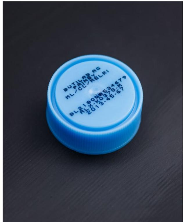
Mikro: 40-Micron-Düse zum Drucken extrem kleiner Zeichen (0,6 mm bis 6 mm)
