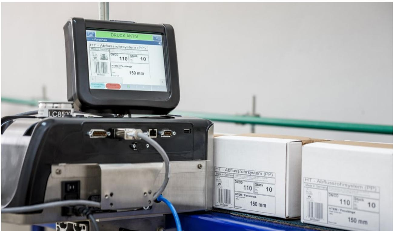
IJ355 und der IJ375 sind hochauflösende Inkjet Drucker, zur direkten und großflächigen Kennzeichnung von Kartonverpackungen. Sie bieten eine hochauflösende Bildqualität, geringe Druckkosten, höchste Flexibilität im Druckdesign und maximale Barcodelesbarkeit auch auf stark faserigen Kartonagen. Die Systeme ersetzen jede bestehende Etikettenlösung sowie vorbedruckte Kartonagen. Je nach Gerätetyp sind 53 mm oder 70 mm Druckhöhe möglich, und erlauben über 70 % Kosteneinsparung gegenüber Etiketten.
