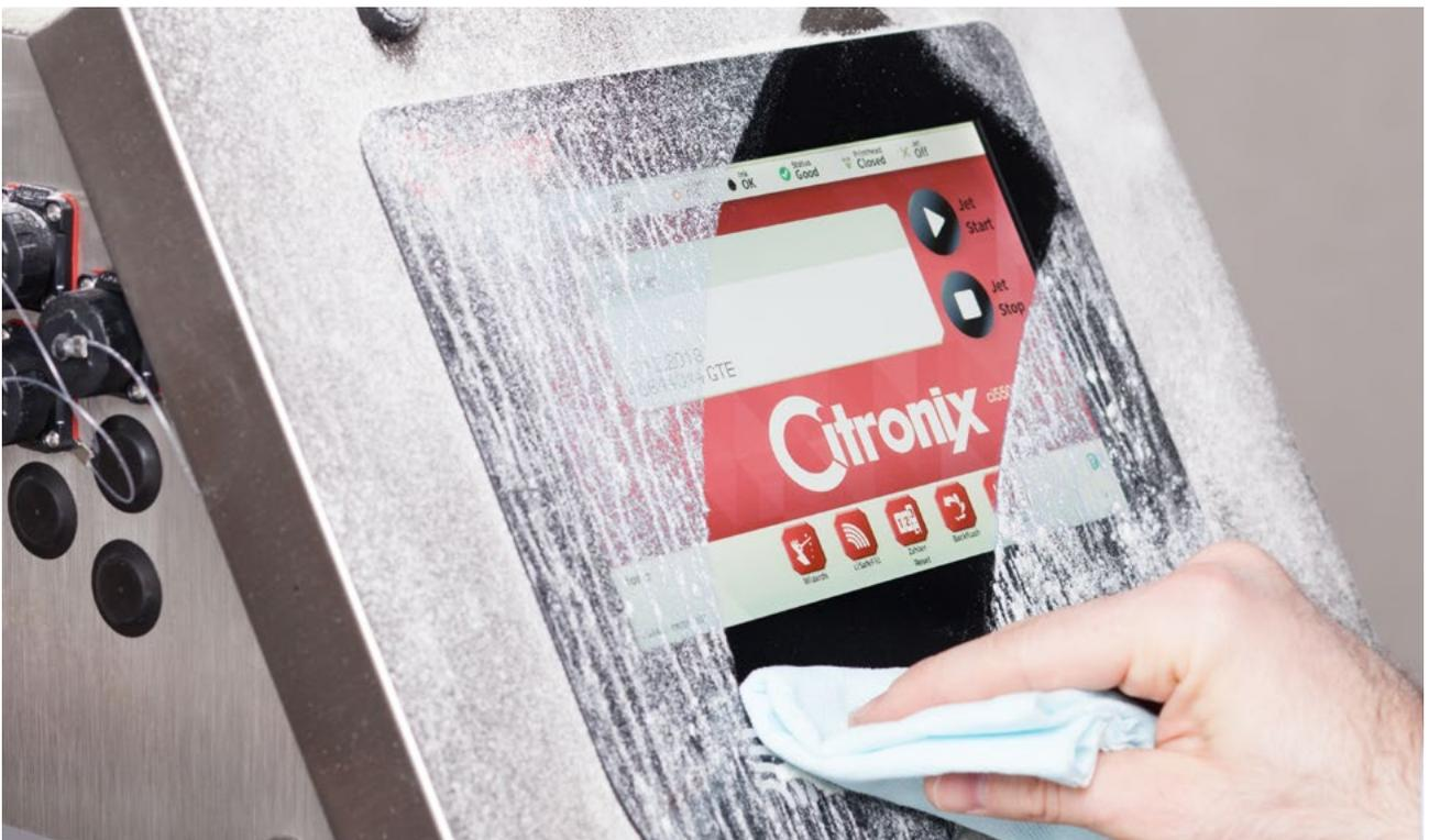
Das Model Ci5650 der Ci5000 Serie unterscheidet sich primär in der nochmals höheren Staubschutzklasse IP65. Das Gehäuse wird hierbei konstant im Überdruck gehalten.
