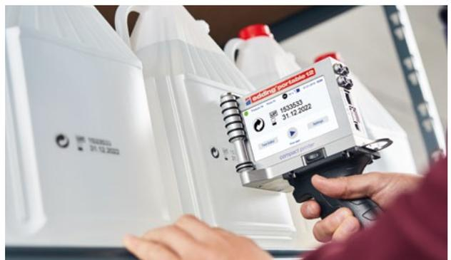
lität überall aufgebracht werden. Das Kartuschensystem ermöglicht den Farbwechsel innerhalb von Sekunden, während der Original Metabo LiHD Akku mit 4 Ah den Drucker nonstop für bis zu 12 Stunden betreiben kann.
