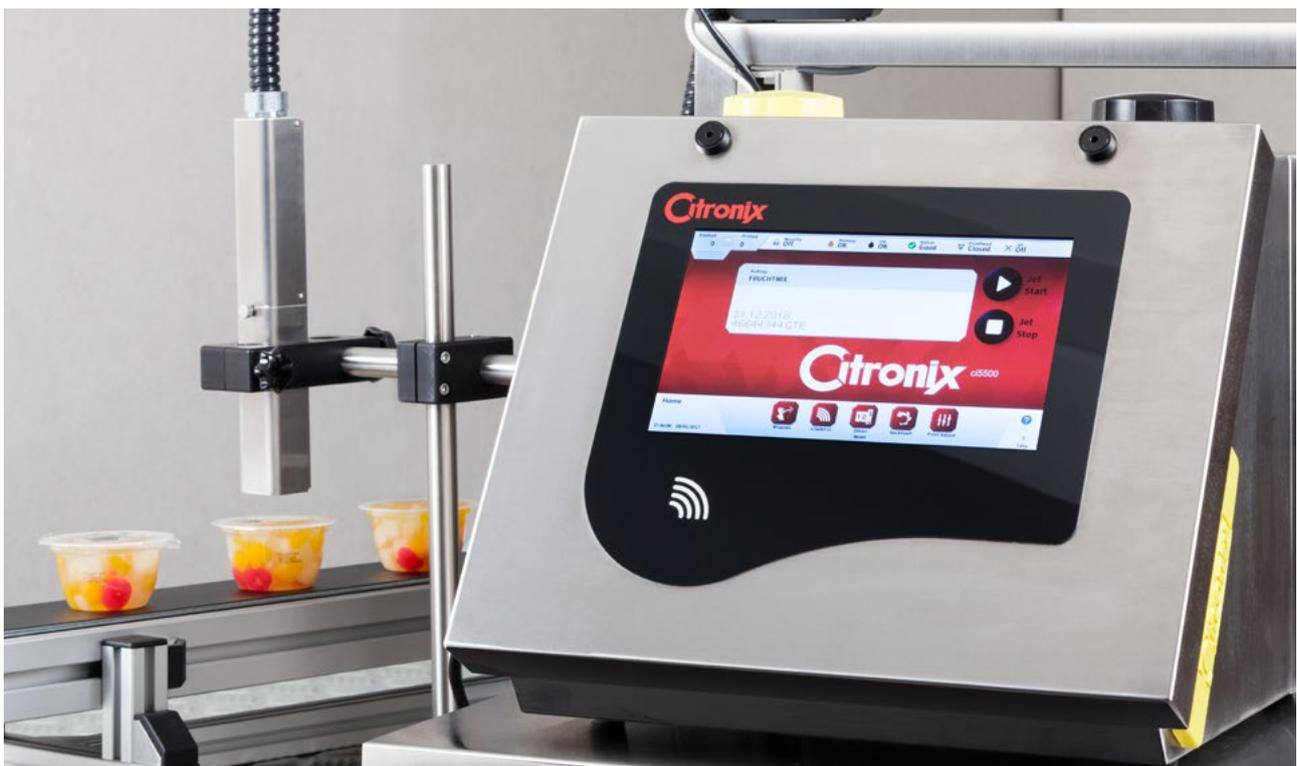
Der Ci5500 ist der fortschrittlichste Hochleistungsdrucker am Markt. Als Spitzenmodell der Ci5000 Serie bietet er echten 5-Zeilen Druck mit einer Schrifthöhe von 1,5 - 12 mm, eine präzise Wiedergabe von Logos und darüber hinaus 2-D Codes in exzellenter Druckschärfe.
