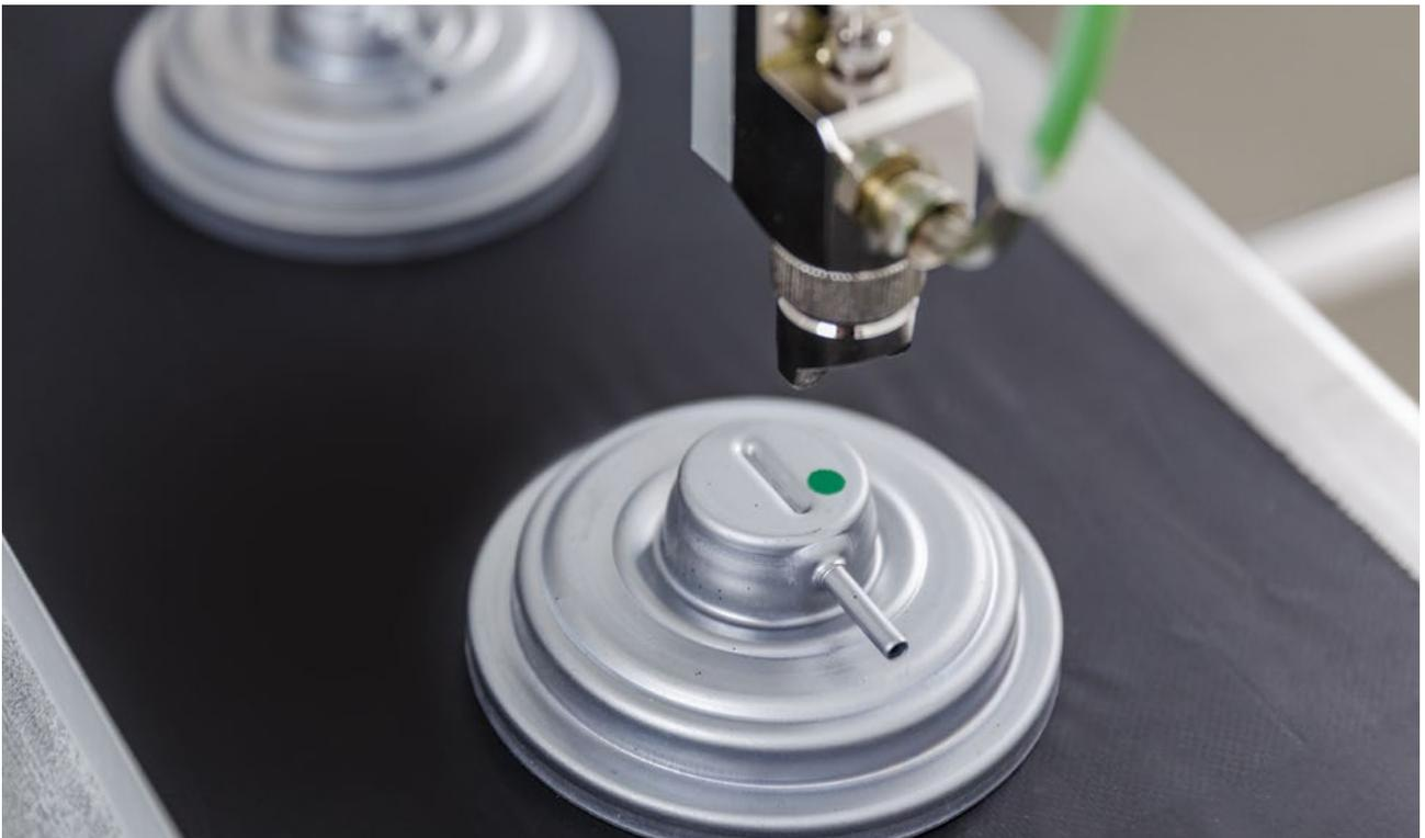
Der Sprayjet ist ein höchst effizientes System insbesondere zur Fehlerkennzeichnung und Qualitätssicherung. Das System sprüht einen Farbpunkt oder Strich auf das vorbeilaufende Material. Da nahezu jede beliebige Tinte verwendet werden kann, ist ein Farbauftrag unabhängig vom Material möglich. Die Auslösung der Markierung erfolgt über ein Magnetventil (24 Volt Signal) oder komplett pneumatisch (Ex-Bereich). Somit ist eine sehr hohe Funktionssicherheit gewährleistet.
